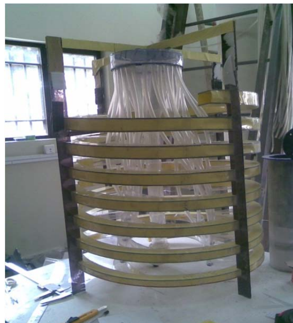
شکل ۴) دستگاه تغلیظکننده غبار ماریپیچ یک‌کاناله ساخته‌شده در آزمایشگاه
