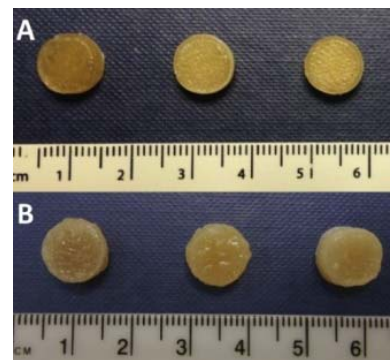
شکل ۱) قرص‌های چاپ‌شده به روش مدل‌سازی رسوبی ذوب‌شده [12]
