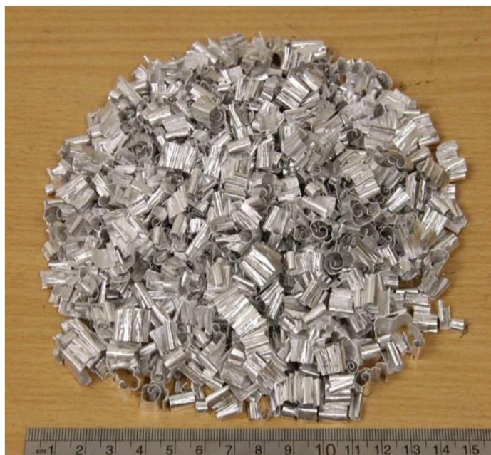
شکل 2 براده‌های منیزیم استفاده شده در فرآیند اکستروژن
