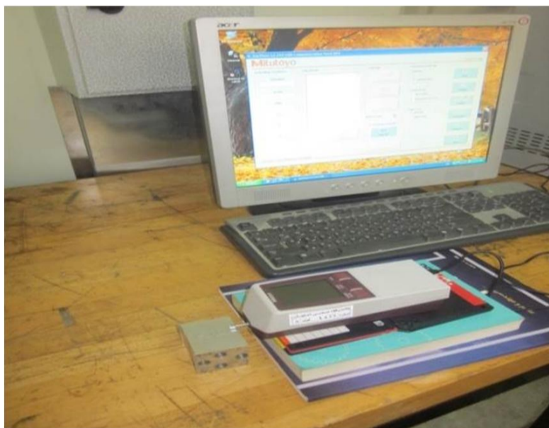
شکل 11 زبری سنج استفاده شده در این تحقیق
