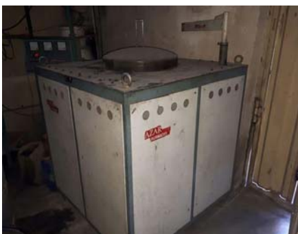
شکل ۳) تصویری از کوره عملیات حرارتی
