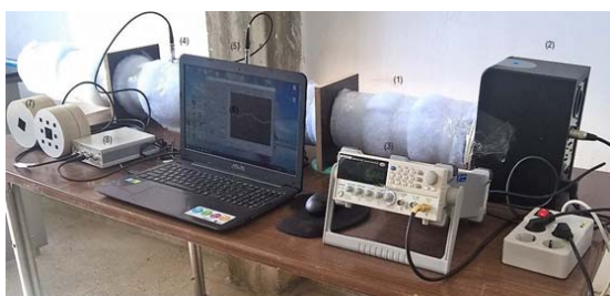
شکل ۳) نمایی از تجهیزات و نحوه اتصال آنها، (۱) لوله امیدانس، (۲) بلندگو، (۳) دستگاه مولد، (۴) و (۵) میکروفن‌ها، (۶) رایانه، (۷) نمونه اسفنج، (۸) کارت صدا
