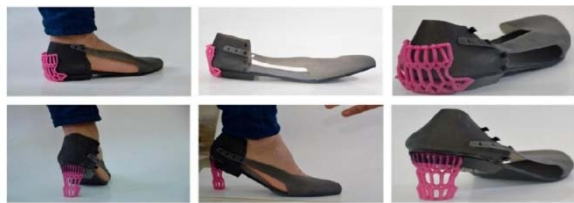
شکل ۲۴) چاپ ۳ بعدی پاشنه متصل‌شده به کفش [72]
