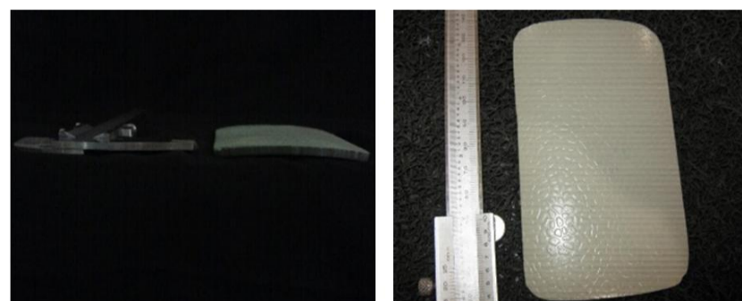
شکل ۲ کفپوش دو لایه پلی‌اورتان/ پلی‌وینیل‌کلراید (نمونه ۲)
