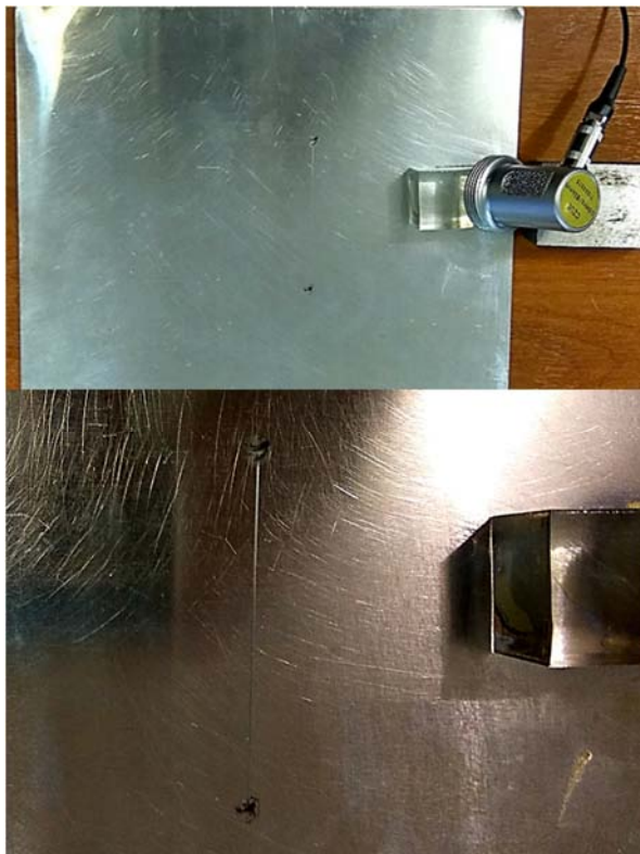
Fig. 5 Experimental test sample in the study of Lamb wave velocity شکل 5 قطعه مورد آزمایش برای سنجش سرعت انتشار موج لمب
