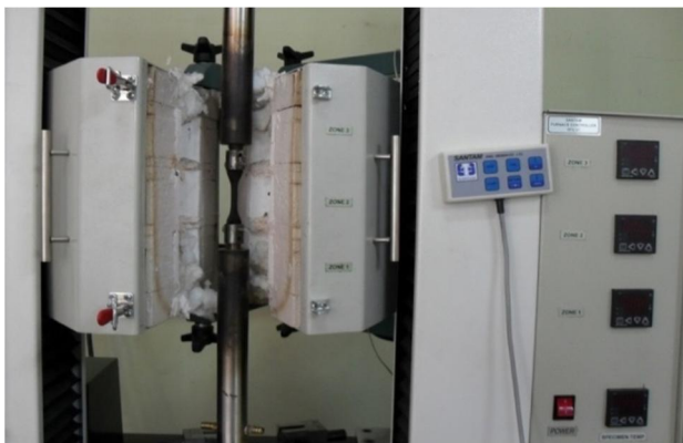
شکل 3 دستگاه آزمایش کشش گرم (آزمایشگاه دانشگاه صنعتی اصفهان - دانشکده مکانیک)
