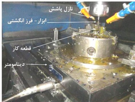
شکل 3 نمایی از چگونگی چیدمان وسایل آزمایش
