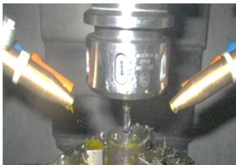
شکل 4 نمایی از آزمایش‌های فرزکاری مارپیچ
