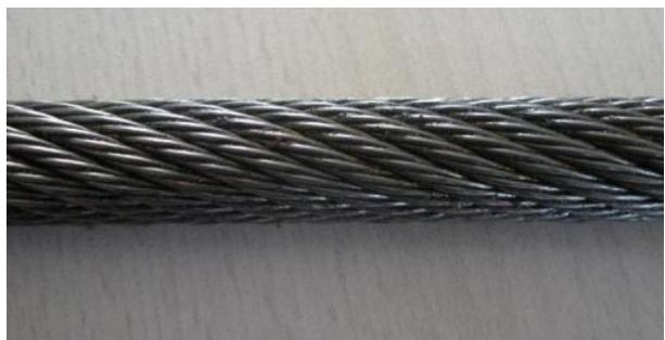
شکل ۴ نمونه سیم چند رشته ای استفاده شده در آزمایش
