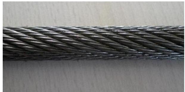
شکل ۴ نمونه سیم چند رشته‌ای استفاده شده در آزمایش
