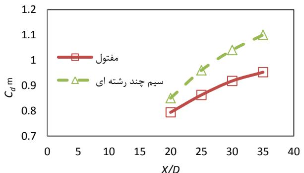
شکل ۸ توزیع ضریب نیروی پسا ناشی از اختلاف مومنت بر حسب فاصله بی بعد شده در پایین دست مدل های مورد آزمایش برای عدد رینولدز ۱۵۷۰
