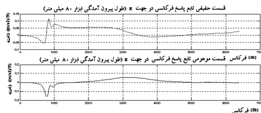
شکل ۶ نمودار تابع پاسخ فرکانسی در جهت X برای طول بیرون آمدگی ابزار برابر ۸۰ میلی متر
