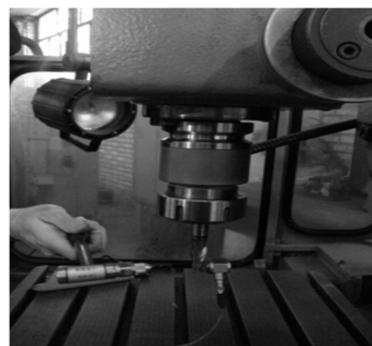
شکل ۳ نحوه انجام آزمایش مودال ابزار
