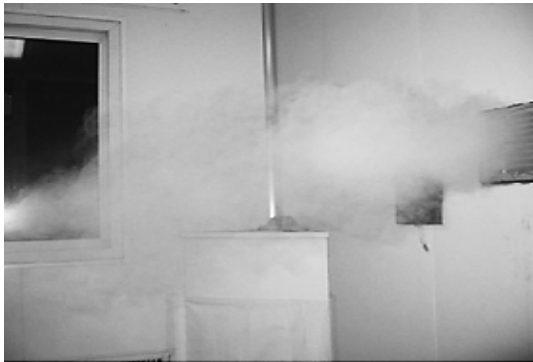
شکل ۳ جریان هوای سیستم تهویه لایه‌ای [۱۰]
