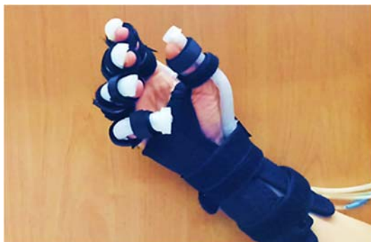
شکل ۹) مود تناسبی دستکش در فشار ۱۷/۰مگاپاسکال و مقادیر خمش متفاوت انگشتان نسبت به یکدیگر
