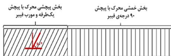
شکل ۴) طرح اولیه محرک نرم مخصوص شست از نمای بالا
