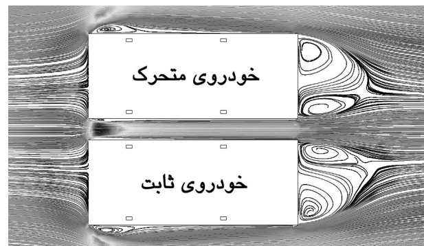
شکل ۱۷ کانتور سرعت جریان در y/w = 0.25
