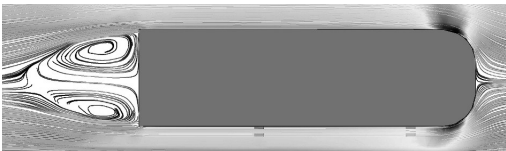
شکل ۸ نمایش بردار سرعت در نقاط مختلف بدنه
