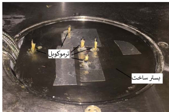
شکل ۱) جایگذاری ترموکوپل در بستر ساخت جهت ثبت تغییرات دمای داخل پودر، موقعیت ترموکوپل ها می تواند بسته به محل ساخت نمونه ها متفاوت باشد.
