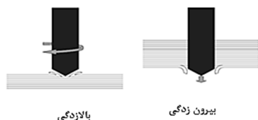
شکل ۱ مکانیزم‌های مختلف تورق در یک ورق کامپوزیتی [۱]
