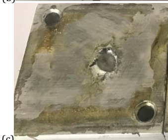
شکل ۷) عمق نفوذ در پشتیبان به وسیله پرتابه با دماغه تخت (a)، نیم کره (b) و اجایو (c)
