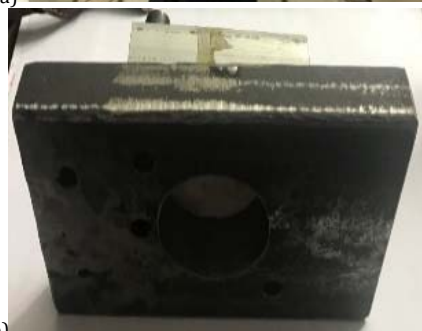
شکل ۵) نمایی از قاب مورد استفاده برای ثابت نگه داشتن هدف؛ قاب اولیه (a) و قاب نهایی (b)
