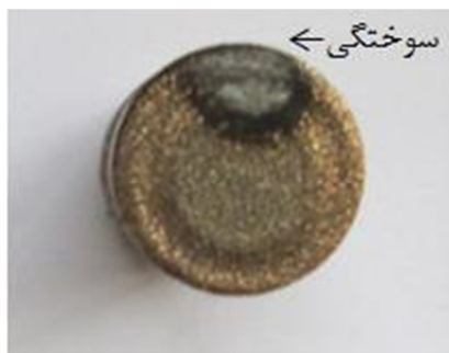
شکل ۷ سوختگی ابزار مس-قلع
