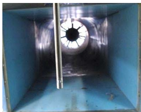
شکل ۷) تصویر حسگر سه‌سوراخه نصب‌شده درون تونل باد جهت فرآیند آزمایش
