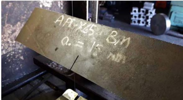
شکل ۵) آماده‌سازی شیار شورون نمونه با استفاده از دستگاه وایرکات
