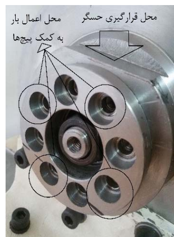
شکل (۴) محل قرارگیری حسگر و اعمال بار
