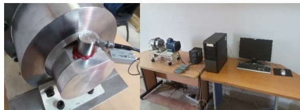
شکل (۵) میز آزمون و محل قرارگیری حسگر
