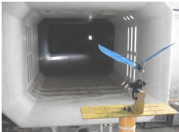
شکل 3 سکوی تست جهت اندازه‌گیری نیروی وارد به تکیه‌گاه
