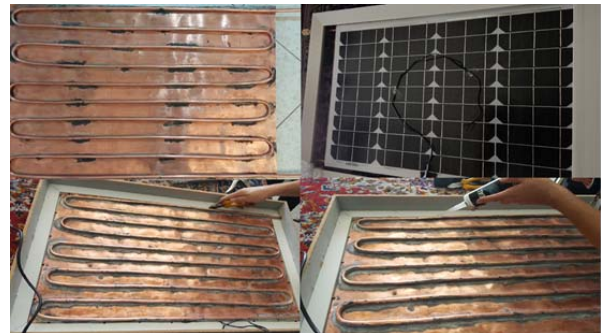
شکل ۸) جزئیات ساخت دستگاه کلکتور ترکیبی فتوولتائیک- حرارتی
