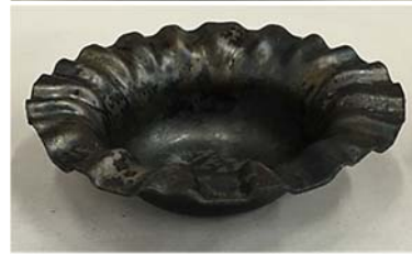
شکل ۲) نمونه‌های شکل گرفته از آزمایش در دماهای مختلف: الف) دمای ۲۰۰ درجه سانتی‌گراد، ب) دمای ۵۰۰ درجه سانتی‌گراد، ج) دمای ۷۰۰ درجه سانتی‌گراد
