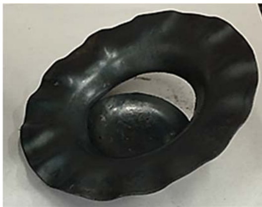
شکل ۷) نمونه شکل‌دهی شده در دمای ۷۵۰ درجه سانتی‌گراد
