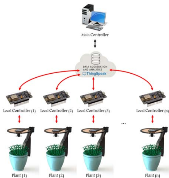
شکل ۲) معماری کنترل‌کننده دو لایه در بستر اینترنت اشیا و اجزای تشکیل دهنده آن شامل کنترل‌کننده اصلی، سرور اینترنت، کنترل‌کننده محلی و زیرسیستم
