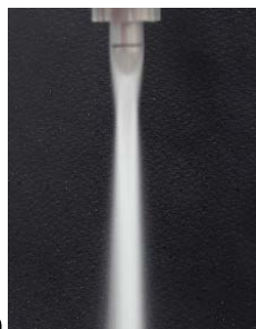
شکل ۲) نحوه عملکرد انژکتور پینتل در تست سرد پاشش آب- آب: الف) فقط جریان شعاعی (داخلی)، ب) فقط جریان محوری (بیرونی)، ج) ترکیب دو جریان شعاعی و محوری
