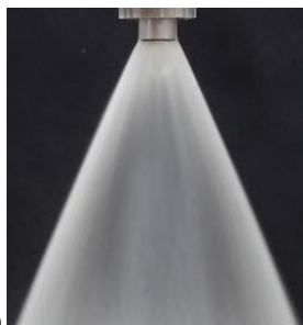
شکل ۲) نحوه عملکرد انژکتور پینتل در تست سرد پاشش آب- آب: الف) فقط جریان شعاعی (داخلی)، ب) فقط جریان محوری (بیرونی)، ج) ترکیب دو جریان شعاعی و محوری
