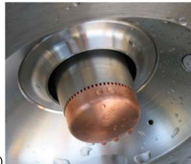
شکل ۳) تصویر انژکتور پینتل دارای تعدادی شکاف در تست سرد با آب [۹] ؛ الف: نمونه تراست بالا، ب: نمونه تراست پایین
