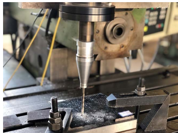
شکل ۴) آماده‌سازی فرآیند سوراخ‌کاری اولتراسونیک
