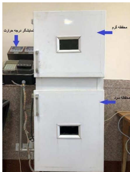
شکل (۲) تصویر دستگاه سیکل حرارتی
