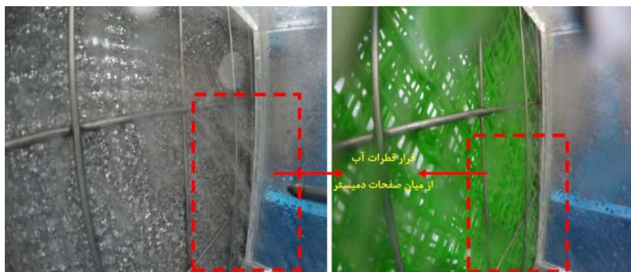
شکل (۷) فرار قطرات آب از صفحات دمیستر پلاستیکی و فلزی در چگالی فشردگی پایین و سرعت جریان هوای بالا
