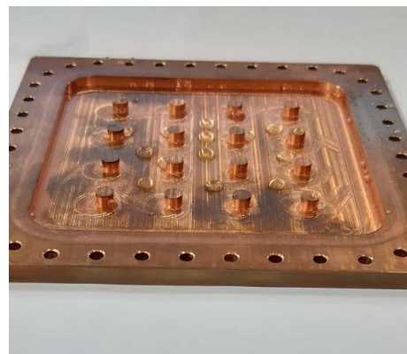
شکل ۴ سطح آبگیزشده بخش چگالش
