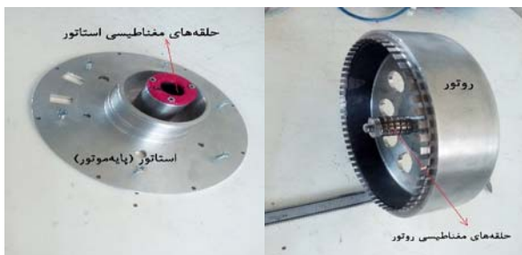
شکل ۵) روتور و استاتور چرخ عکس‌العملی به همراه مغناطیس‌های دائمی مونتاژی
