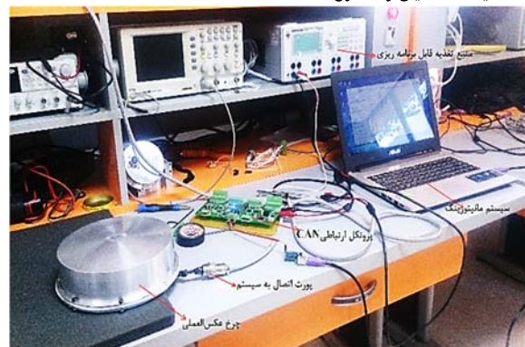
شکل ۱۰ اجزای راه‌اندازی آزمایش تجربی عملگر چرخ عکس‌عملی
