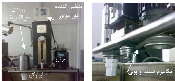
شکل ۱ تجهیزات آزمایشگاهی (الف) دستگاه اسپارک تهران اکرام (ب) مکانیزم اضافه شده برای دوران ابزار
