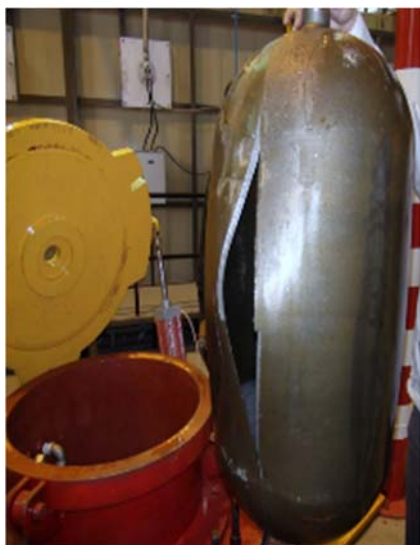
شکل ۳) مخزن مورد آزمون در فشار نهایی
