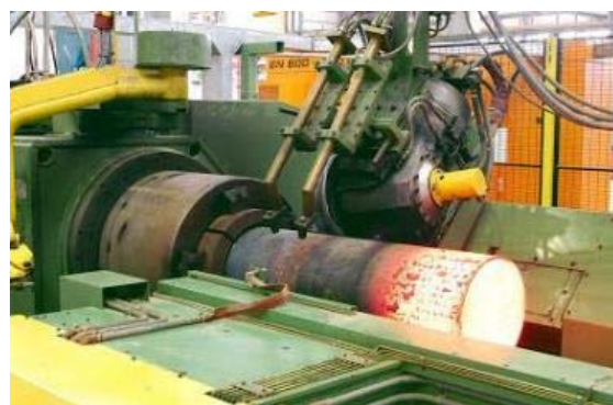
شکل ۱) ساخت مخزن از لوله بدون درز
