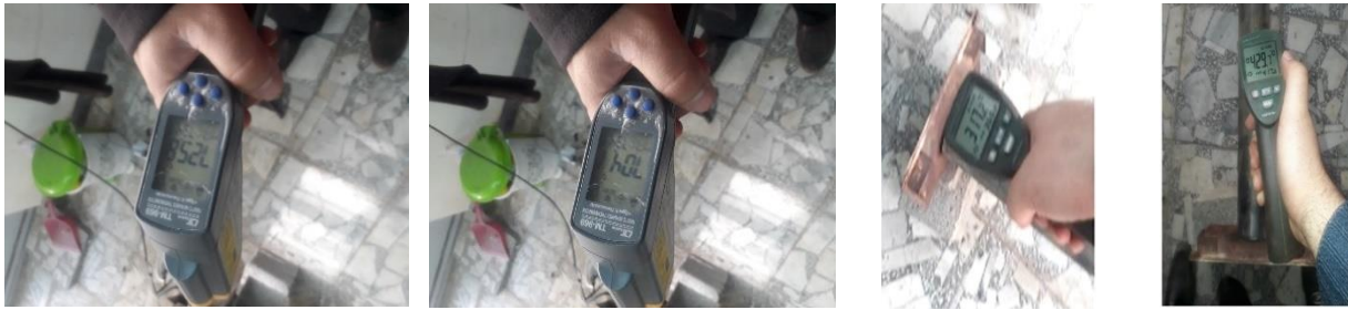
شکل ۲۴) ثبت دمای سطح بالای لوله تابنده
