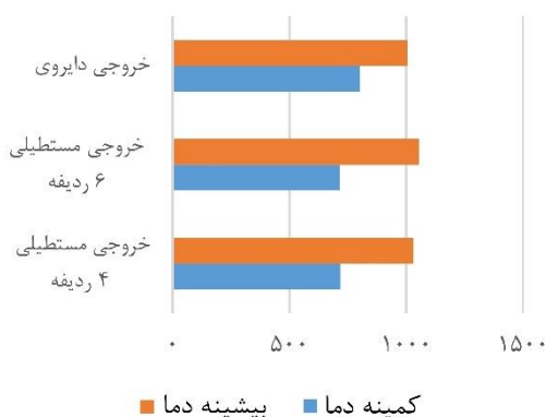
شکل ۱۶ کمینه و بیشینه دمای پدید آمده در سه طرح از لوله تابنده
