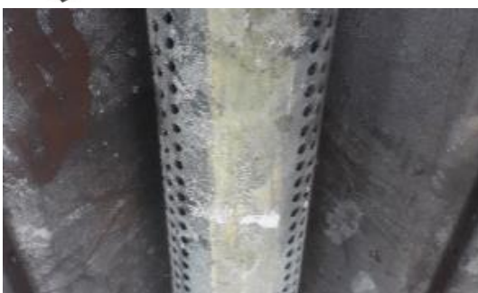
شکل ۱) نمایی از مشعل گازسوز تابشی با خروجی‌های سیال تعبیه شده در جداره
