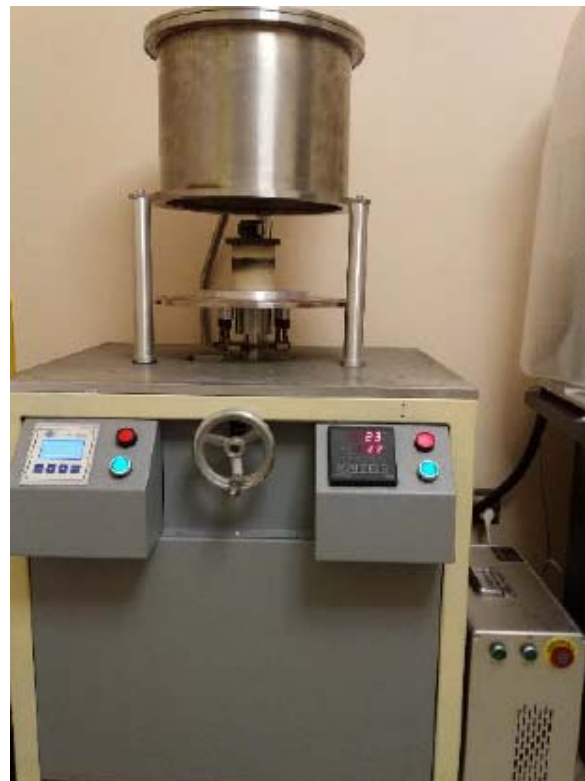
شکل (۲) کوره مورد استفاده جهت انجام جوش‌کاری فاز مایع‌گذرا
