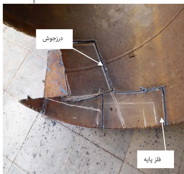
شکل ۵) موقعیت و جهت نمونه آزمایش خمش سه نقطه‌ای: (a) درزجوش، (b) فلز پایه در لوله واقعی با درزجوش مارپیچ [17]
