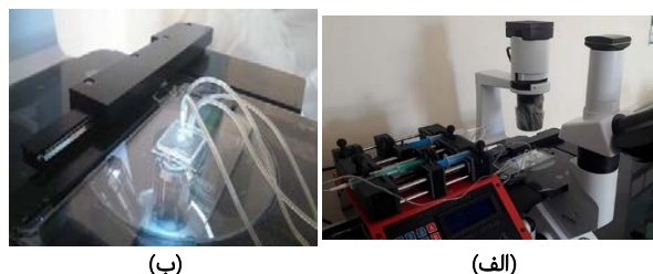
شکل ۶) الف) تجهیزات به‌کاررفته، ب) میکروکانال به‌کاررفته به همراه لوله‌های اتصالی
