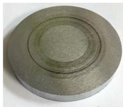
شکل ۴) دیسک تهیه شده از جنس ST37
