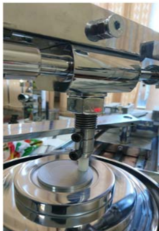
شکل ۵) آماده سازی پین و دیسک بر روی دستگاه آزمون سایش
