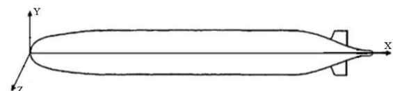
شکل ۲) نمایی از زیرسطحی DARPA SUBOFF همراه با دستگاه مختصات کارتزین در ابتدای دماغه آن
