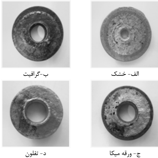
شکل ۸ نمونه‌های فشار داده شده تحت روانکارهای مختلف
