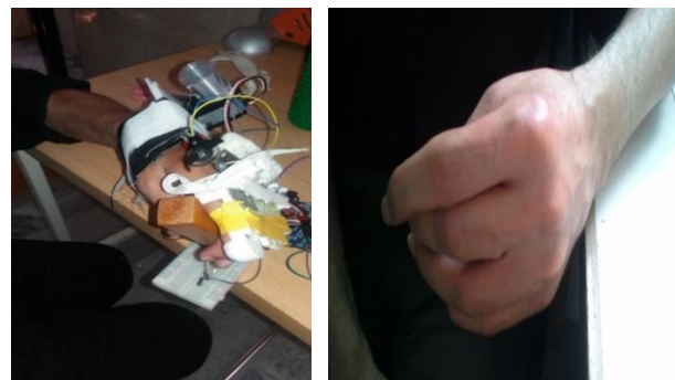
شکل ۱۶) تست عملی ربات ساخته شده بر روی بیمار در دانشگاه ایران. (الف) دست بیمار (ب) بازشدن دست بیمار توسط ربات و گرفتن جسم
