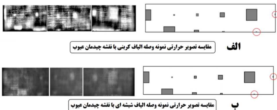
شکل ۷) تصاویر حرارتی نمونه‌ها با کامپوزیت هشت لایه‌ای
