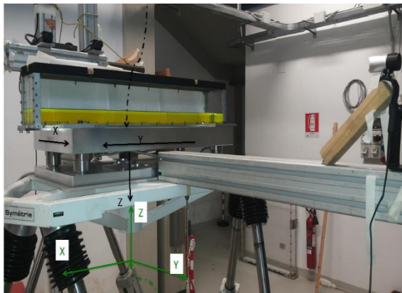
شکل ۴) مخزن اسلاشینگ و شرایط آزمایش برای تست‌های اسلاشینگ مجزا در CNR-INSEAN، رم، ایتالیا.
