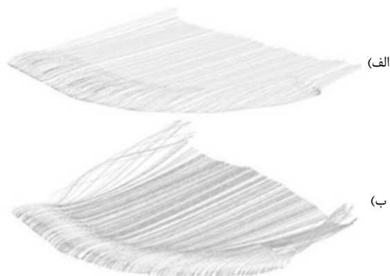
شکل 19 خطوط جریان روی سطح بال تغییر شکل یافته سوئیپ، الف) زاویه حمله صفر درجه، ب) زاویه حمله 15 درجه
