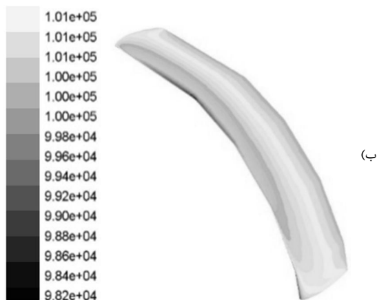
شکل 18 توزیع فشار بر حسب پاسکال روی سطح بال تغییر شکل یافته گال، الف) زاویه حمله صفر درجه، ب) زاویه حمله 15 درجه
