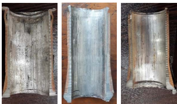
شکل ۵) قطعه دولایه مس پوسته و آلومینیوم هسته متصل شده در نسبت کاهش ضخامت ۴۵٪ (الف) دمای ۲۰۰ °C، (ب) ۳۰۰ °C، (ج) ۴۰۰ °C
