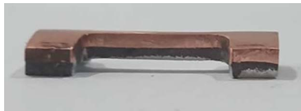
شکل ۸) نمونه تست کشش قطعه دوفلزی
