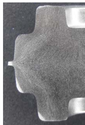
شکل ۱۱) نمایش نحوه سیلان مواد در آهنگری داغ همدمای آلومینیوم ۶۰۶۱
