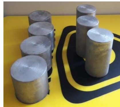
شکل ۱۱) آماده سازی شمش های اولیه با قطرهای ۳۵ و ۲۸ میلی متر جهت انجام آهنگری همدمای
