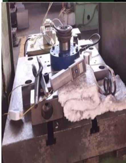
شکل ۵) دستگاه پرس هیدرولیک ۶۳ تن مورد استفاده جهت آهنگری و موقعیت سنسور وزن، قالب و تجهیزات گرمایشی مورد استفاده بر میز دستگاه
