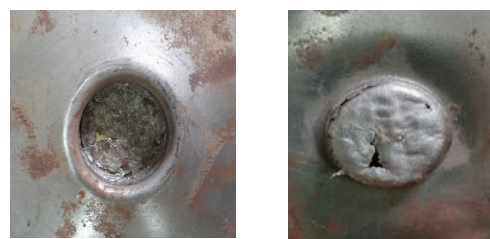
شکل ۸) جوشکاری دو ورق فولادی با پرتابه مسطح ( t=1\text{mm} , SD=0.1\text{mm} )
