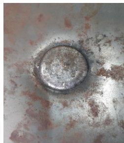
شکل (۲) جوشکاری دو ورق فولادی با پرتابه مسطح (t=3mm, SD=0.1mm)
