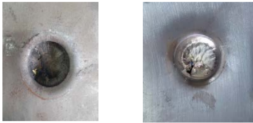
شکل ۶) جوشکاری دو ورق فولادی با پرتابه مسطح ( t=2\text{mm} , SD=0.1\text{mm} )
