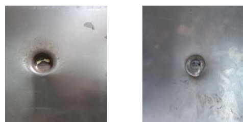
شکل ۹) جوشکاری دو ورق فولادی با پرتابه کرومی ( t=1\text{mm} , SD=0.1\text{mm} )
