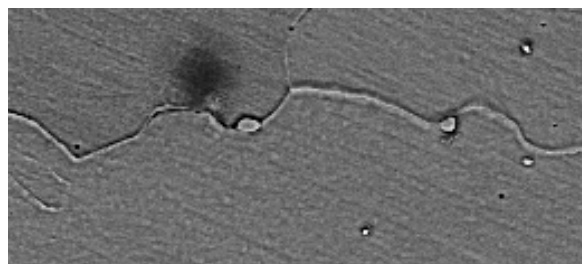
شکل ۹) جوشکاری دو ورق فولادی با پرتابه کروی ( t=3\text{mm} , SD=0.2\text{mm} )
