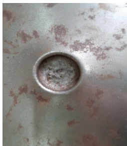
شکل (۲) جوشکاری دو ورق فولادی با پرتابه مسطح (t=3mm, SD=0.1mm)
