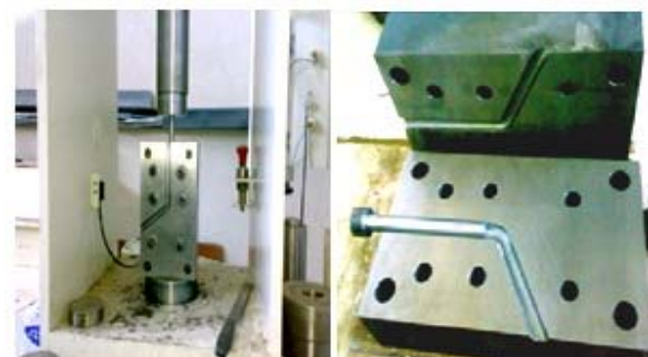
شکل (۳) قالب ECAP و پرس استفاده‌شده
